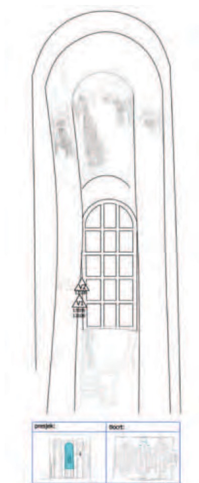
6. Crkva Sv. Mihovila, Ston, sjeverni zid, crtež s označenim mjestima uzimanja uzoraka (dokumentacija HRZ-a, nacrtala K. Gavrilica)
