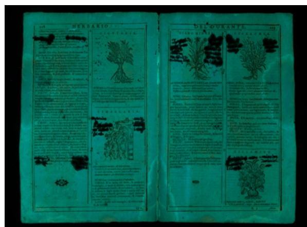
14. UVF snimak s vidljivom poodmaklom degradacijom papira na mjestu željezno-galne tinte (potpuna apsorpcija UV zračenja) (Fotoarhiv NSK, snimka: D. Čizmek, 2018.) UV imaging with visible advanced paper degradation where the iron-gall ink was used (complete absorption of UV radiation) (NSK Photo Archive, D. Čizmek, 2018)
