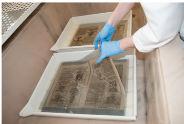
3. Premještanje araka iz stabilizacijske u neutralizacijsku otopinu pomoću metalne mrežice (Fotoarhiv NSK, snimka: S. Hrelja, 2018.) Moving sheets from the stabilizing to the neutralizing solution using a metal mesh (NSK Photo Archive, S. Hrelja, 2018)
