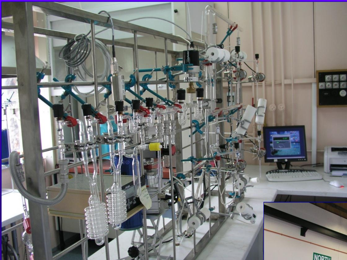
*Vakuumska linija za sintezu grafta za AMS mjerjenje*
