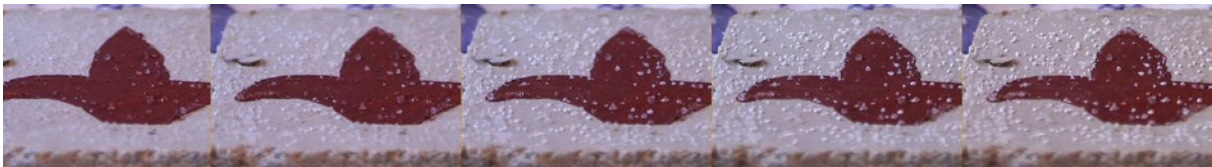
| Formation of eruptions due to thenardite salts crystallisation on test samples. Photos taken in 10 min interval range Formiranje izbočina djelovanjem tenarditnih soli na testnim uzorcima. Fotografije snimljene u 10-minutnim intervalima
