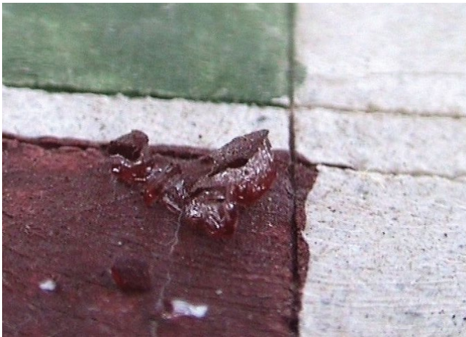
| Formation of eruptions due to thenardite salts crystallisation on test samples. Photos taken in 10 min interval range Formiranje izbočina djelovanjem tenarditnih soli na testnim uzorcima. Fotografije snimljene u 10-minutnim intervalima
