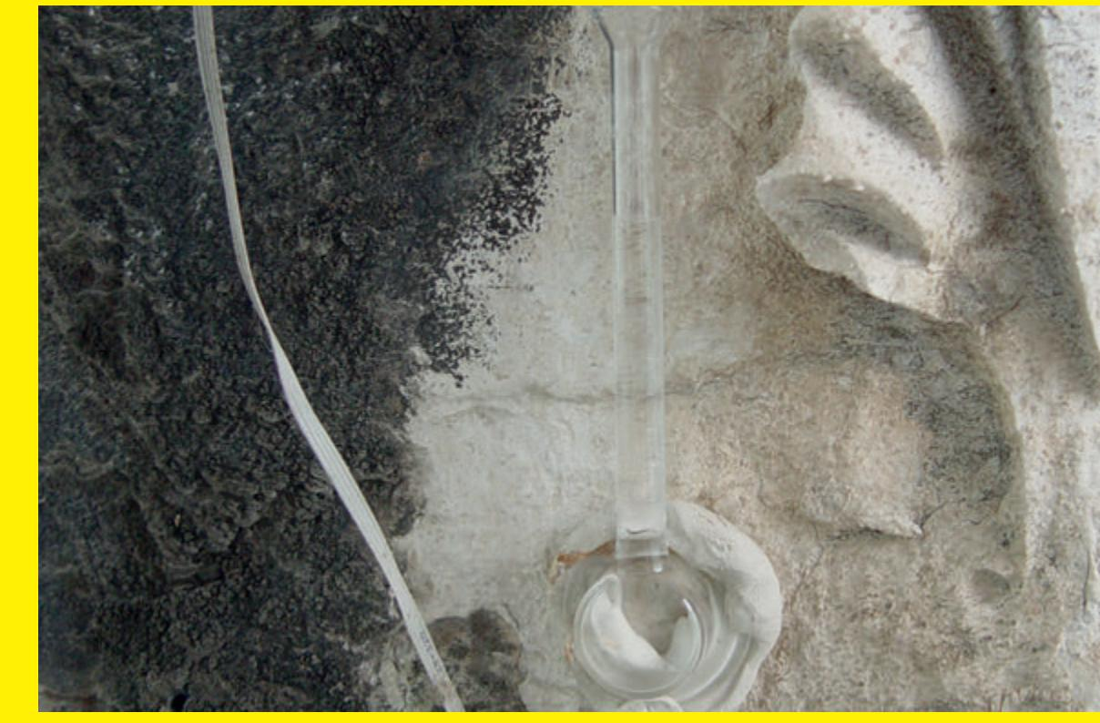
Mjerjenje vodoupojnosti kamena Karstenovim cilindrom
