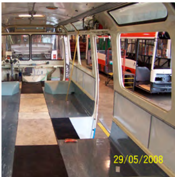
13. Lijepljenje novih podnih obloga u interijeru autobusa Karosa ŠL 11.1305 (TMB, snimka: T. Kocman, 2008.)
