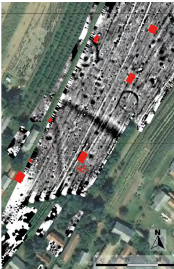
2. Plan probnih soni na podlozi rezultata geofizičkog istraživanja (arhiva HRZ-a, geofizičko istraživanje: Eastern Atlas GmbH & Co. KG, 2019.)
