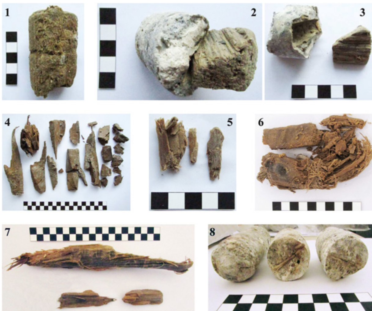
5. Uzorci drvenih pilota pronađeni ispod kamenih temelja u atriju Kneževa dvora (Dokumentacija o arheološkom nadzoru, Zavod za obnovu Dubrovnika, snimila N. Topić, 2016.)
