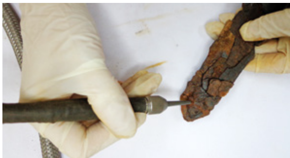
6. Mikropjeskarenje željeznog mača (fototeka HRZ-a, snimila E. Perkočić)
