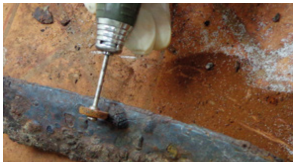
5. Uklanjanje produkata korozije mikromotorom (fototeka HRZ-a, snimila E. Perkočić)
