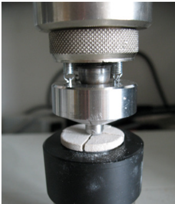
18. Postupak mjerenja mehaničkih svojstava (statičkog modula elastičnosti i biaksijalne savojno-vlačne čvrstoće) testnog uzorka mase za injektiranje s uređajem DO-FB010TN, Zwick/Roell (snimio B. Hacker, 2009.)
