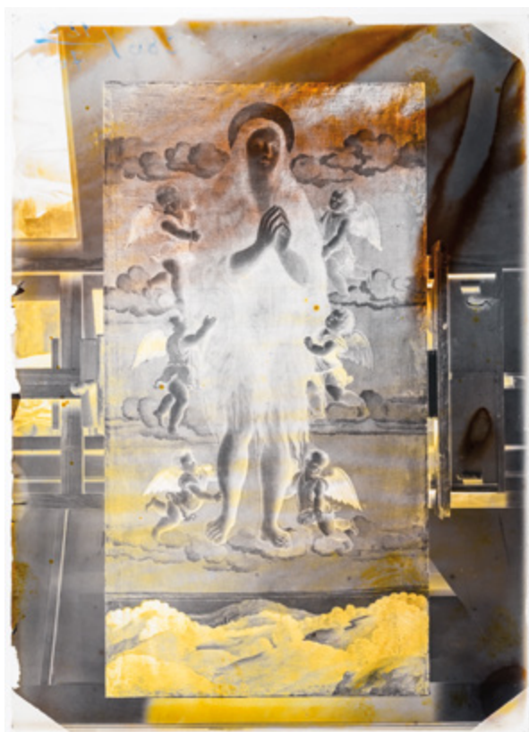
4. Teži oblik degradacije emulzijskog sloja (fototeka HRZ-a, snimio Lj. Gamulin)
