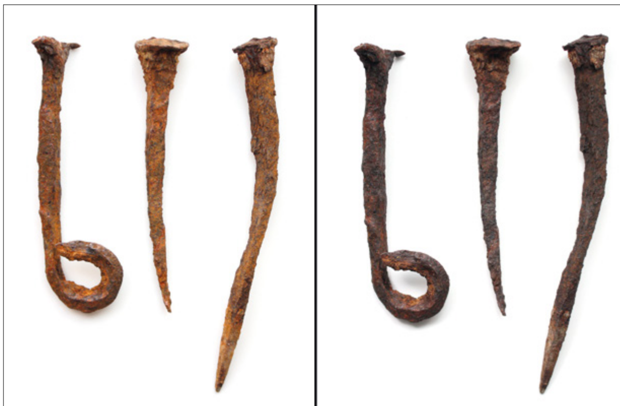
2. Skupina tretirana elektrolitskom redukcijom. Lijevo - stanje prije, desno - stanje nakon ekstrakcije klorida (snimio J. Kralik, 2015.) Group treated by electrolytic reduction. Left: condition before, right: condition after extracting the chlorides (photo by J. Kralik, 2015)
