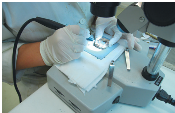
7. Uklanjanje korozivnih slojeva ultrazvučnom iglom (fototeka HRZ-a, snimio M. Mustaček)
