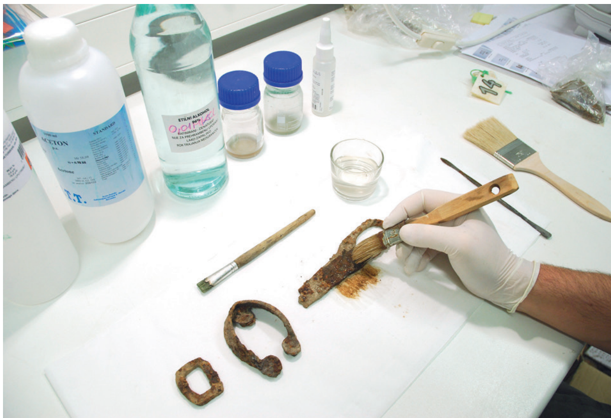
2. Preliminarno čišćenje željeznih predmeta (fototeka HRZ-a, snimio M. Mustaček)
