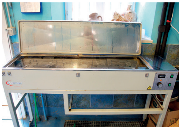
3. Kupelj za sulfadni postupak (fototeka HRZ-a, snimio M. Mustaček)
