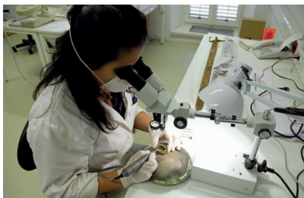
9. Brušenje korozivnog sloja mikromotorom (fototeka HRZ-a, snimio M. Mustaček)
