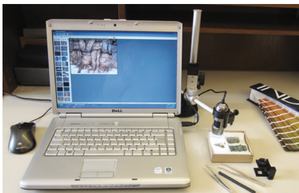
9. Textile analysis with Dino-Lite Microscope (photo: K. Grömer). Analiza tekstila Dino-Lite mikroskopom (snimila: K. Grömer)
