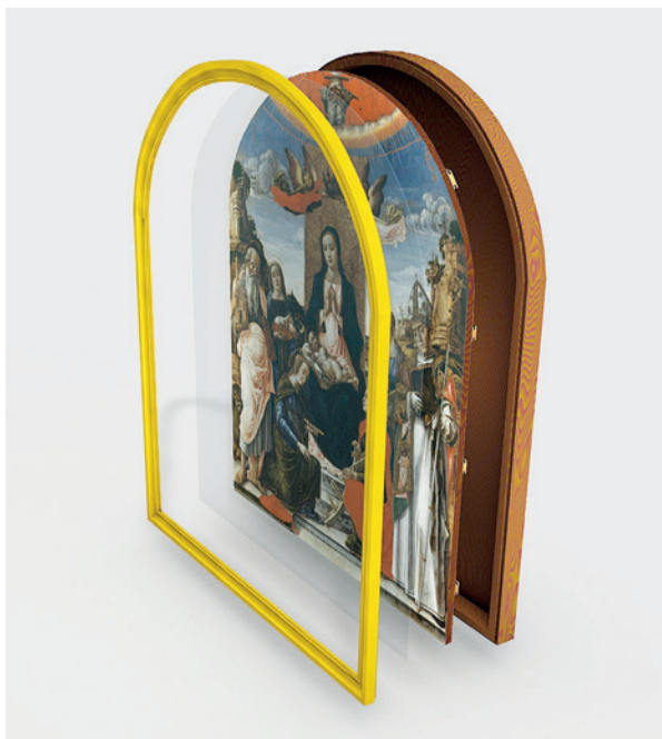
13. Prikaz konstrukcije mikroklimatske vitrine (dokumentacija HRZ-a, autor ilustracije O. Šuman).
