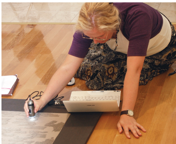
10. Analyzing the Pustopolje textile with Dino-Lite Microscope; looking through the net (photo: Jo Sofaer, K. Grömer). Analiza tekstilnog predmeta iz Pustopolja pomoću Dino-Lite mikroskopa; pogled kroz mrežu (snimile: Jo Sofaer, K. Grömer)
