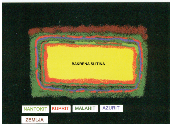
FORMIRANJE BAKRENIH KARBONATA I POČETNIH ŽARIŠTA NANTOKITA
