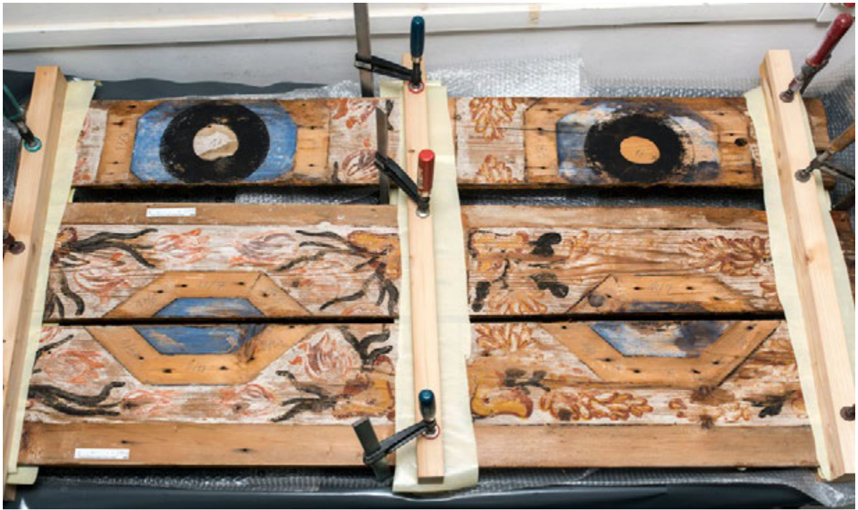
9. Sušenje dasaka nakon natapanja tekućim konsolidantom (arhiva HRZ-a, snimka: J. Kliska, 2017.) Planks drying after being saturated with liquid consolidator (HRZ Archive, J. Kliska, 2017)
