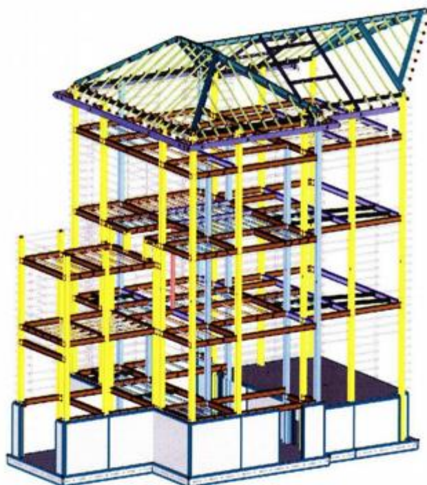
Prostorni FE model konstrukcije nožice
