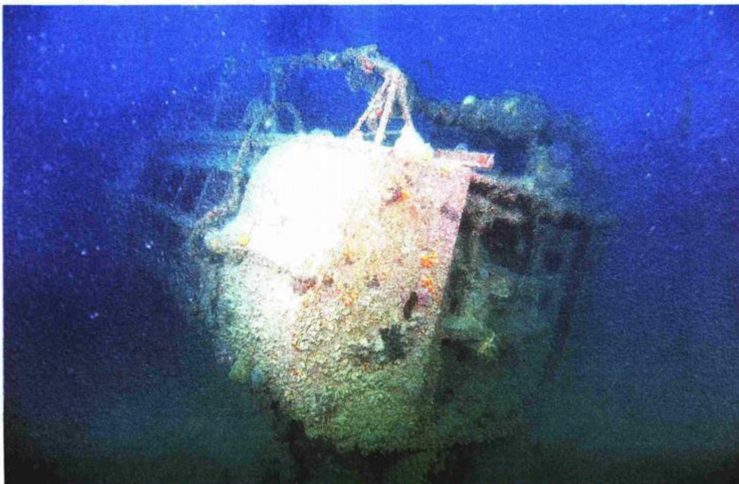
Stražnja panorama krmenog dijela broda, uočljiv nedostatak propelera na vidljivoj osovinu motora
