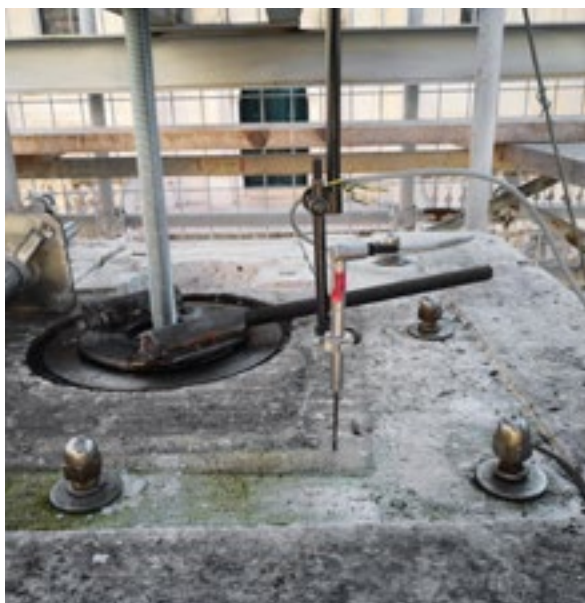
Dubrovnik, Orlandov stup, pokušaj strojnog otpuštanja sile centralnog trna – mjerni uređaj. Snimka: A. Gluhan, 2024.
