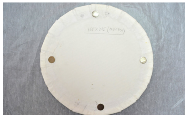
11. Zalijepljeni neodimijski magneti na poledinu prototipa (fototeka HRZ-a, snimila M. Begić Jarić, 2015.) Neodymium magnets glued to the back of the prototype (Croatian Conservation Institute Photo Archive; M. Begić Jarić, 2015)
