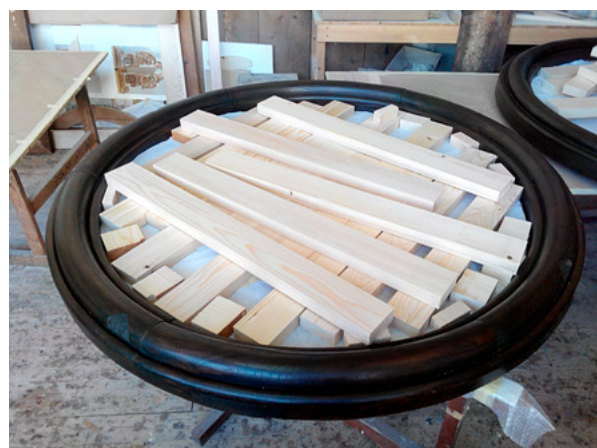
18. Jednokratno optežavanje prilikom lijepljenja neodimijskih magneta na drveni ukrasni okvir i magneta na poledinu arhivskog valovitog kartona (fototeka HRZ-a, snimila M. Begić Jarić, 2015.)
