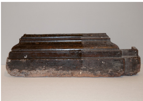
12. Profil s donjeg dijela ormara, tijekom kemijskog čišćenja (fototeka HRZ-a, snimio D. Gazde, 2010.)
